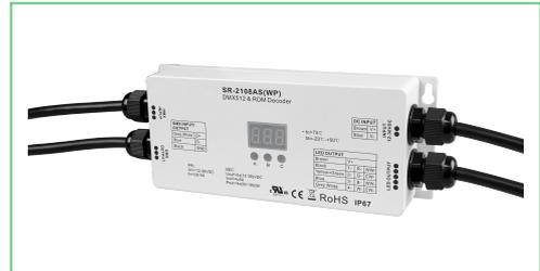
Wasserdichter DMX512 LED-Controller mit 4 Kanälen à 5A, 12–36 V, RDM-Funktion, einstellbarer PWM-Frequenz (200 Hz–35 kHz) und Schutzart IP67 – ideal für Außenbeleuchtung.
